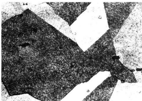
1. Mikroštruktúra austenitickej ocele (zv. 400x) – Microstructure of austenitic steel (400x magn.)
