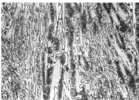
5. Mikroštruktúra bielej liatiny (zv. 400x) – Microstructure of white cast iron (magn. 400x)
